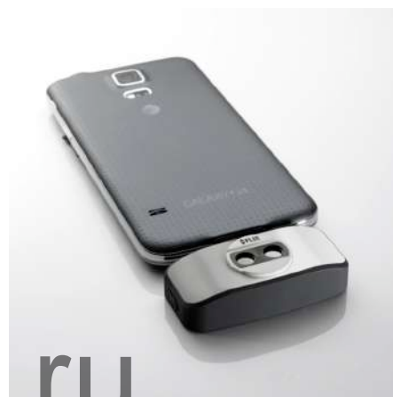
Рисунок 19.3 2015 г.: FLIR One, приложение для мобильных телефонов с операционной системой iPhone и Android. Вес: 90 г.
