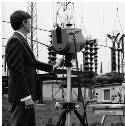
Рисунок 15.2 1969 г.: Thermovision модель 661. Эта камера весила около 25 кг, осциллограф – 20 кг, а штатив – 15 кг. Кроме того, оператору требовался генератор переменного напряжения на 220 В и сосуд на 10 л с жидким азотом. Слева от осциллографа видна фотоприставка Polaroid (6 кг).
