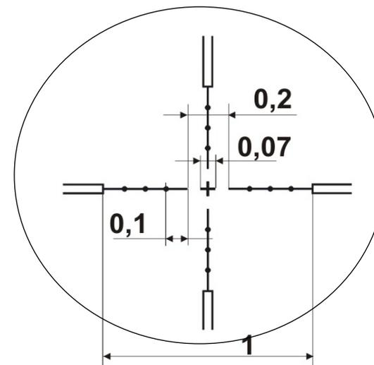
Рисунок 6 – Внешний вид прицельной сетки для модели «Dedal-490-DK3 (165)»
