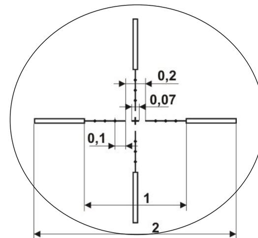
Рисунок 5 – Внешний вид прицельной сетки для модели «Dedal-490-DK3 (100)»
