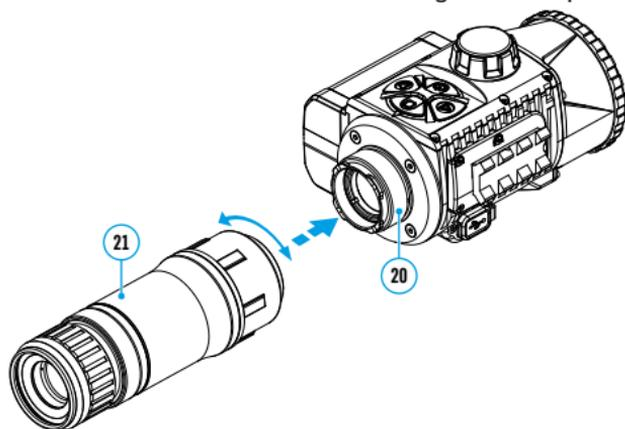
**Remarque:** le monoculaire peut être installé sur un module d'imagerie thermique avec un adaptateur déjà installé.
