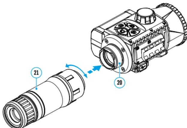
**Hinweis:** Das Monokular kann mit einem bereits installierten Adapter an einem Wärmebildmodul installiert werden.
