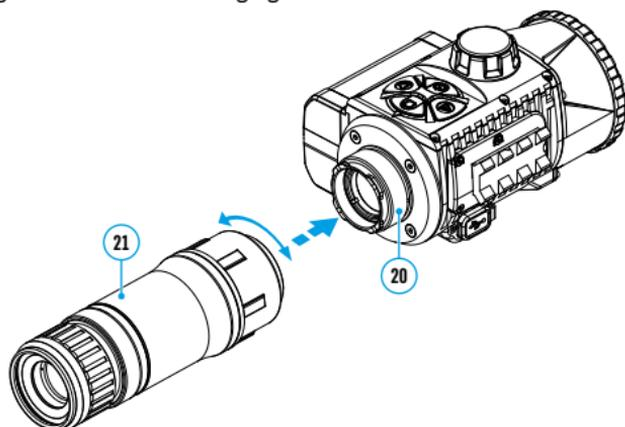
**Nota:** il monoculare può essere installato su un modulo di imaging termico con un adattatore già installato.
