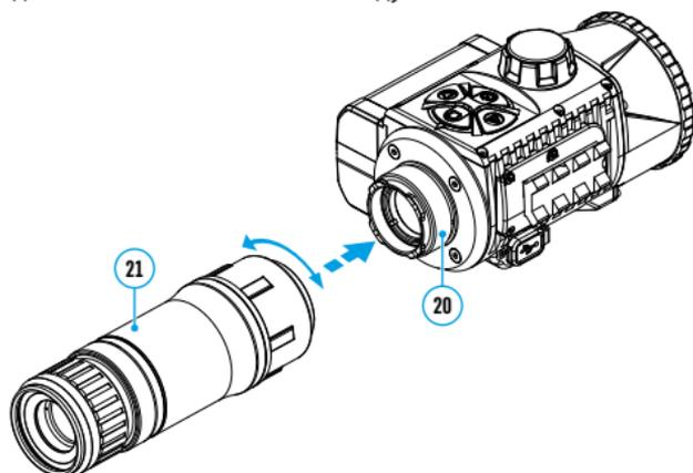
**Примечание:** монокуляр можно устанавливать на тепловизионный модуль с уже установленным адаптером.
