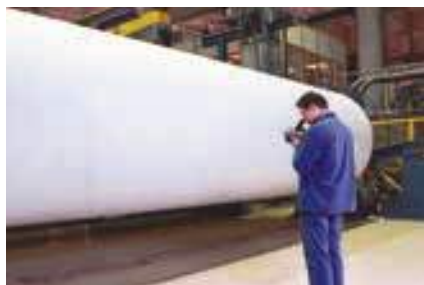
Проверка распределения влаги в бумажной массе при скорости прохождения бумажного полотна 1 600 метров в минуту
