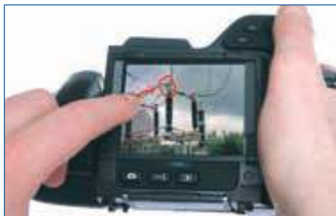
То же изображение с использованием технологии MSX. Надпись под предохранителем можно прочитать, поэтому найти и отремонтировать нужный предохранитель не составит труда
