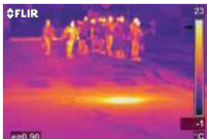
Тепловизионные изображения позволяют мгновенно локализовать место прорыва трубы водопровода горячей воды, проложенного под землей
