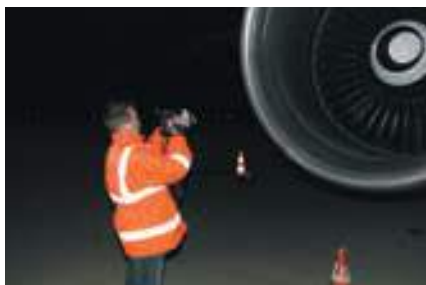
Осмотр деталей самолета при помощи тепловизионной камеры
