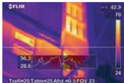
Визуальное и ИК-изображение направляющей сборной шины в производственном цехе
