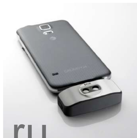
Figure 13.3 2015 г.: FLIR One, вспомогательное устройство для мобильных телефонов с операционной системой iPhone и Android. Вес: 90 г. .
