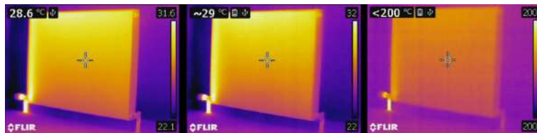
Figure 36.4 Изображения, полученные при помощи FLIR T440, с диапазонами температур от -20 до +120^{\circ}\text{C} , (левое изображение), от 0 до +650^{\circ}\text{C} (среднее изображение) и от +250 до +1200^{\circ}\text{C} (правое изображение). Все остальные настройки остаются неизменными.
