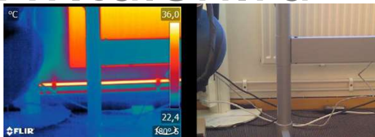
Figure 36.6 “Термографическая проверка” недоступного объекта.
