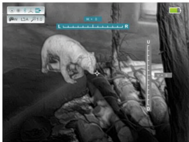
Рисунок 5-5. Интерфейс лазерной калибровки
