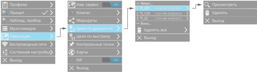
При каждом измерении дальности до цели прибор автоматически определяет географические координаты цели и ее высоту над уровнем Земли. Также производится автоматическая запись фото с тепловизионным изображением и картой местности с отображением цели.
