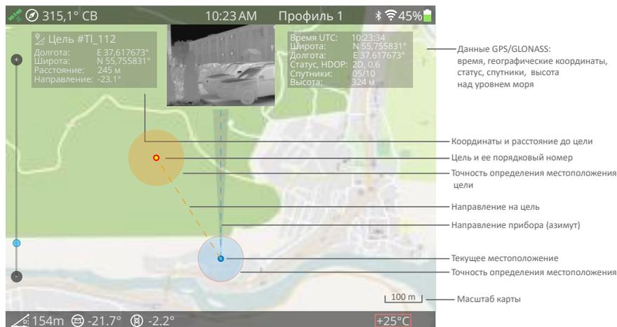
Навигационный экран позволяет определить свое положение на карте местности, а также определить местоположение цели; просмотреть пройденный путь, контрольные точки.
