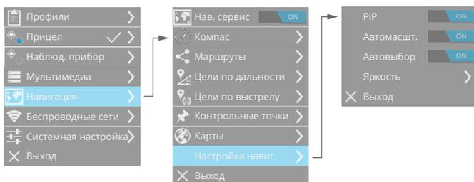
Также можно настроить яркость изображения в режиме навигации, включить/выключить PiP в режиме навигации.
