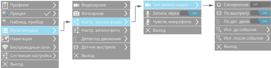
Устройство позволяет производить запись видео (с или без аудио). Запись видео производится вручную - 2-х секундным нажатием кнопки Запись, или в автоматическом режиме - по датчику выстрела и/или по детектору движения.
