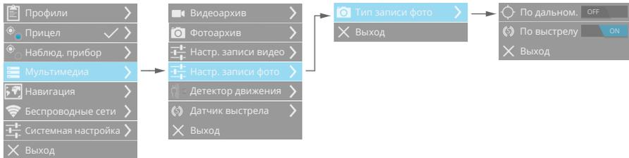
Устройство позволяет производить запись фото. Запись фото производится вручную кратковременным нажатием кнопки Запись или в автоматическом режиме - при измерении дистанции, по выстрелу.
