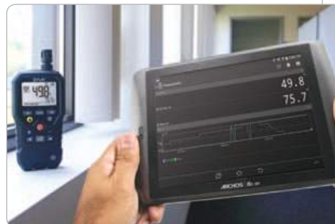
MR77 передает данные на планшет с Android используя приложение FLIR Tools Mobile.
