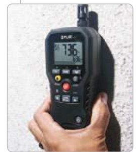
FLIR MR77 снабжен как бесконтактным датчиком влажности так и проводным щупом
