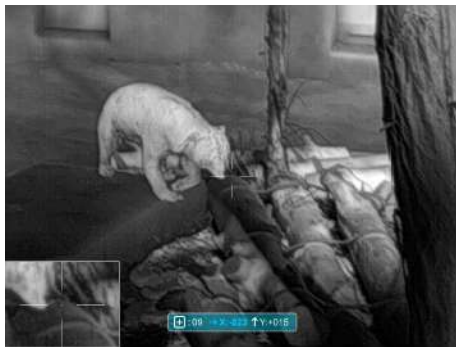
Рис. 17. Интерфейс функции коррекции «битых» пикселей.
