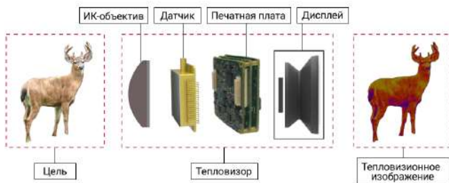
Рис. 1. Схема формирования изображения тепловизором.
