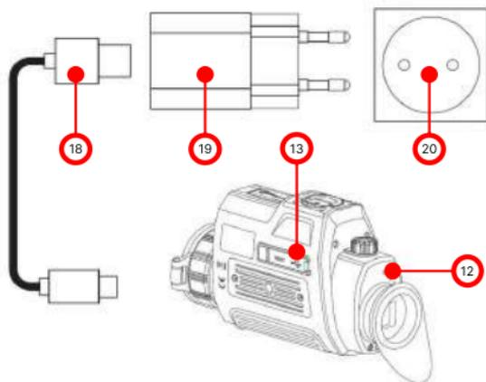
Рис. 2. Подключение прибора для зарядки от сети.
