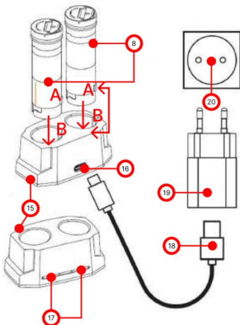
Рис. 3. Зарядка аккумуляторов в зарядном устройстве.
