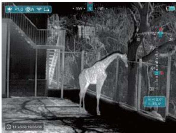
Рис. 10. Интерфейс режима угломера.
