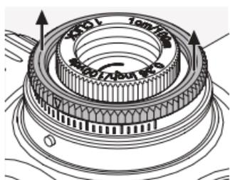
1. Soulevez la bague moletée extérieure et maintenez-la dans cette position pendant que vous la tournez. La bague moletée ne reste pas seule en position relevée ; dans cette position, elle ne permet pas de régler le réticule.
