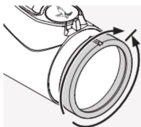
Ruotate prima l'anello di compensazione diottrica completamente verso sinistra (in senso antiorario) e poi verso destra, fino a raggiungere la nitidezza massima del reticolo.
