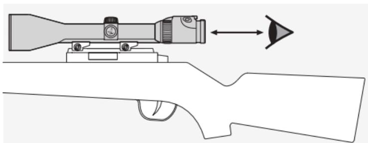
Ställ in korrekt ögonsavstånd för kikarsikten som monteras på vapen (måttan hittar du i det tekniska databladet).
