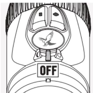
Drehen Sie hierzu den AUS/TAG/NACHT-Schalter in die Mittelstellung.
