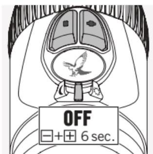
Puede desactivar la función SWAROLIGHT llevando el interruptor DESACTIVADO/DÍA/NOCHE a la posición central y pulsando los botones +/- simultáneamente durante 6 segundos. La luz parpadeará dos veces para confirmar que se desactiva la función. Puede volver a activar SWAROLIGHT repitiendo este paso.
