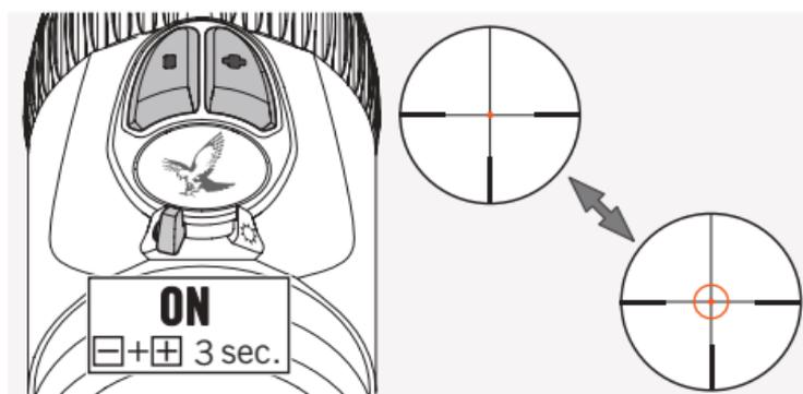
Kytke FLEXCHANGE 4X-F -ristikon valaistu rengas käyttöön kääntämällä POIS/PÄIVÄ/YÖ-kytkin PÄIVÄ- tai YÖ-asentoon. Ristikon valaistus on nyt aktivoitu. Kytke valaistu rengas käyttöön painamalla painikkeita +/- samaan aikaan kolmen sekunnin ajan. Kytke rengas pois käytöstä toistamalla tämä vaihe.
