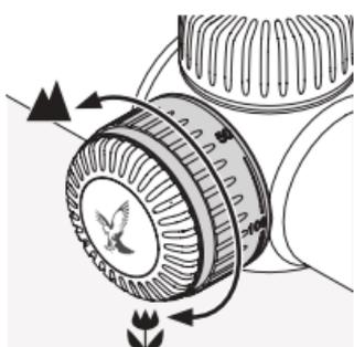
Med parallaksetårnet kan du indstille skarpheden for enhver afstand til byttet og forhindre sigtefejl på grund af parallakse.
