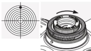
Vrid den yttre räfflade ringen på topptoronet i motsatt riktning mot H (dvs. medsols).
