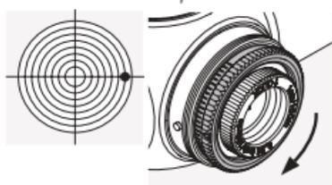
Tournez la bague moletée extérieure de la tourelle latérale dans le sens inverse de la flèche R (sens des aiguilles d'une montre).
