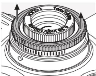
1. Løft den ydre drejeknap, og hold den i den hævede position, mens den drejes. Den forbliver ikke i den hævede position af sig selv.
