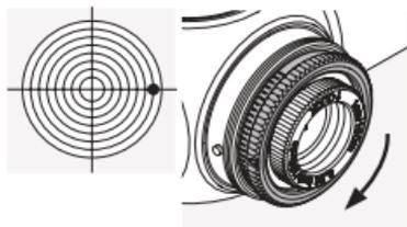
Vrid den yttre räfflade ringen på sidotoronet i motsatt riktning mot R (dvs. medsols).
