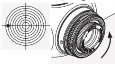
Tournez la bague moletée extérieure de la tourelle latérale dans le sens de la flèche R (sens inverse des aiguilles d'une montre).
