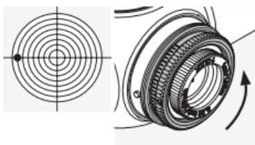
Ruotate l'anello zigrinato esterno sulla torretta laterale in direzione della R (senso antiorario).
