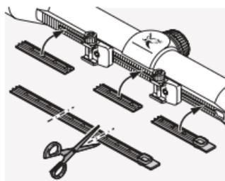
Предлагаемую заглушку можно использовать для защиты открытых областей крепежной планки. Ее можно отрезать до требуемого размера и вдавить пальцами в крепежную планку.
