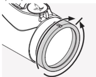
Сначала поверните кольцо диоптрической настройки влево (против часовой стрелки) до упора, а затем поворачивайте вправо, пока прицельная марка не будет в резком фокусе.
