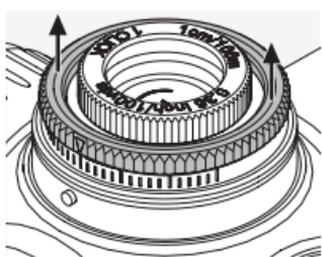
1. Heben Sie den äußeren Rändelring an, der in dieser Stellung gehalten und dann entsprechend gedreht werden muss. Er bleibt nicht selbstständig in dieser angehobenen Position.
