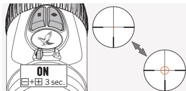
Draai de UIT/DAG/NACHT-schakelaar in de DAG of NACHT-positie om de verlichte ring van het dradenkruis FLEXCHANGE 4A-IF in te schakelen. De dradenkruisverlichting is nu ingeschakeld. Houd de +/- knoppen tegelijkertijd 3 seconden lang ingedrukt om de verlichte ring in te schakelen. Herhaal deze stap om de ring weer uit te schakelen.
