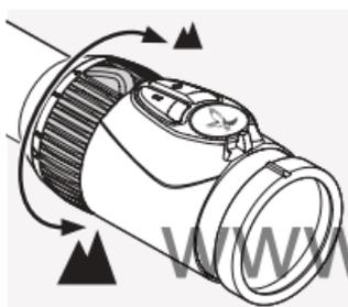
Ruotate l'anello di regolazione dell'ingrandimento di 180° per ottenere l'ingrandimento che desiderate. La regolazione avverrà di conseguenza. La scala sull'anello di regolazione
