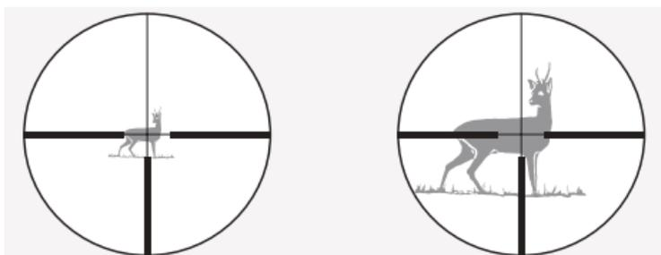
Selbst bei hohen Vergrößerungen wird nur wenig vom Ziel verdeckt. Ein Schätzen der Entfernung mit Hilfe des Absehens ist nur bedingt möglich.
