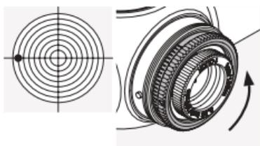
Vrid den yttre räfflade ringen på sidotoronet i pilriktningen R (dvs. motsols).
