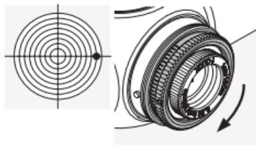
Drehen Sie den äußeren Rändelring der Seitenverstellung entgegen der Pfeilrichtung R - im Uhrzeigersinn.
