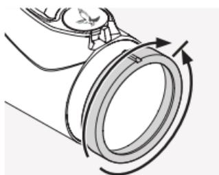
Käännä ensin silmäkohtainen säätörengas täysin vasemmalle (vastapäivään) ja sitten oikealle, kunnes ristikko on täysin tarkentunut. Säätövara vaihtelee malleittain. Lisätietoja on tuotteen teknisissä tiedoissa.
