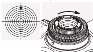
Tournez la bague moletée extérieure de la tourelle supérieure dans le sens inverse de la flèche H (sens des aiguilles d'une montre).
