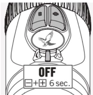
Sie können die SWAROLIGHT Funktion deaktivieren. Drehen Sie hierzu den AUS/TAG/NACHT-Schalter in die Mittelstellung und drücken dann die +/- Tasten gleichzeitig für 6 Sekunden. Ein zweimaliges
