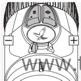
Du kan nu reglera ljusstyrkan i det valda läget med hjälp av knapparna + och -. För att snabbt hitta rätt ljusstyrka kan du hålla aktuell knapp intyckt (lång puls). Om du vill finjustera trycker du en gång på knappen (enstaka puls).
