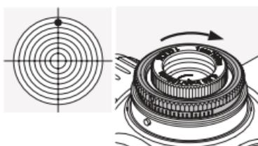
Draai de kartelring aan de buitenkant op de toren aan de bovenzijde tegen de pijlrichting H in (met de klok mee).
