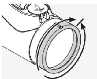
Primero, gire la anilla de ajuste de dioptrías completamente hacia la izquierda (sentido anti horario) y, posteriormente, gírela hacia la derecha hasta que vea la retícula nítida y enfocada.
