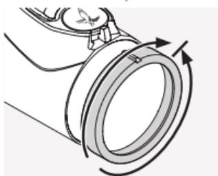
Drehen Sie erst den Dioptrienstellring ganz nach links (gegen den Uhrzeigersinn) und dann nach rechts, bis das Absehen die optimale Schärfe zeigt.
