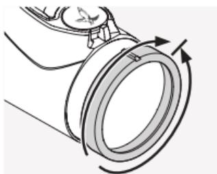
D'abord, tournez la bague d'ajustement dioptrique entièrement vers la gauche (sens inverse des aiguilles d'une montre), puis vers la droite, jusqu'à ce que la mise au point du réticule soit
