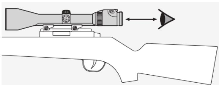
Impostate la giusta distanza della pupilla d'uscita per un cannocchiale montato su un'arma (consultate la scheda dati tecnica per le misure).
