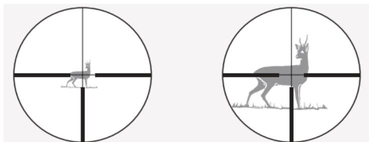
deel van het doel afgedekt. Het schatten van de afstand met behulp van het dradenkruis is maar in beperkte mate mogelijk.
