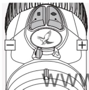
Una volta selezionata questa modalità, potete regolare la luminosità grazie ai tasti +/- . Per ottenere rapidamente il livello ideale di luminosità, tenete premuto uno dei tasti (impulso prolungato). Per regolazioni di precisione, premete i tasti una volta (impulso singolo).
