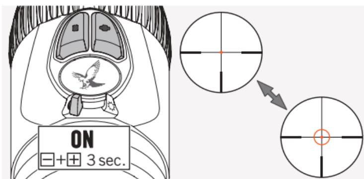
Déplacez le sélecteur ARRÊT/JOUR/NUIT en position JOUR ou NUIT pour activer l'anneau éclairé du réticule FLEXCHANGE 4A-IF. L'éclairage du réticule est maintenant activé. Appuyez simultanément sur les boutons +/- pendant 3 secondes pour activer l'anneau éclairé. Répétez cette étape pour désactiver l'anneau éclairé.
