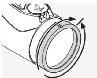
Drej først dioptriindstillingsringen helt til venstre (mod uret), og derefter til højre, indtil sigtet viser optimal skarphed. Indstillingsområdet afhænger af den individuelle model. Du kan finde
