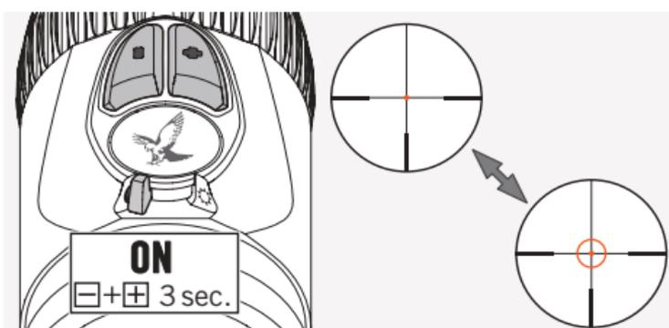
Lleve el interruptor DESACTIVADO/DÍA/NOCHE a la posición DÍA o NOCHE para activar el anillo iluminado de la retícula FLEXCHANGE 4A-IF. La iluminación de la retícula quedará activada. Pulse los botones +/- simultáneamente durante 3 segundos para activar el anillo iluminado. Repita este paso para volver a desactivar el anillo.
