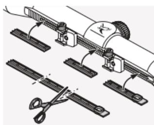
Die beiliegende Abdeckung dient zum Schutz der freiliegenden Schienenteile. Sie kann auf die notwendige Größe zugeschnitten und mit der Hand in die Schiene gedrückt werden.
