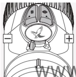
Nyt kirkkautta voidaan säätää valitussa tilassa painikkeilla +/- . Ihanteellinen kirkkaustaso voidaan saavuttaa nopeasti painamalla ja pitämällä yhtä painiketta painettuna (pitkä pulssi). Tarkkoja säätöjä tehdään painamalla jompaakumpaa painiketta kerran (yksittäinen pulssi).
