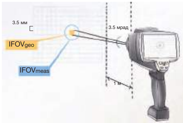
Рис 1.4: Поле зрения отдельного пикселя
