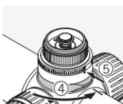
Otevřete uzamykací mechanismus na věžičce. Otočte označení na věžičce na nulovou hodnotu, pokud se přesunulo do jiné pozice.
