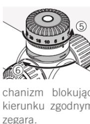
Następnie można wybrać ustawienia, które mają się znaleźć na pokrętłe. Aby zablokować pokrętło, należy obrócić mechanizm blokujący o ćwierć obrotu w kierunku zgodnym z ruchem wskazówek zegara.
