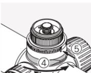
Откройте механизм блокировки на турели. Верните маркировку на турели к нулю, если она сместилась на другую позицию.
