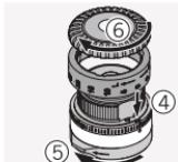
Postavite desni/levi gradirani prsten. Uverite se da je nula poravnata sa indeksnom tačkom. Zatim zatvorite mehanizam za zaključavanje. Ponovo zatvorite izrečani prsten na turet.
