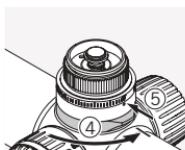
Deschideți mecanismul de blocare al turelei. Setați marcajul turelei pe zero dacă acesta își schimbă poziția.
