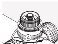
Otvorite mehanizam za zaključavanje okretne glave. Ako se pomaknula na drugi položaj, oznaku na okretnoj glavi postavite na nulu.
