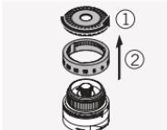
Odkręcić znajdujący się na pokrętle pierścień moletowany. Zdjąć pierścień moletowany i pierścień z podziałką (lub pierścień znakujące).
