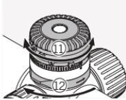
Теперь вы можете выбирать желаемые настройки. Поверните механизм блокировки на четверть оборота по часовой стрелке, чтобы зафиксировать его.
