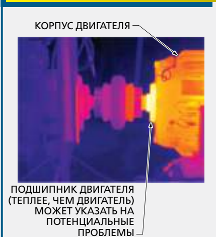
Рис. 2-2. Подшипник двигателя, который значительно теплее, чем корпус двигателя, указывает на возможные проблемы со смазкой или соосностью.
