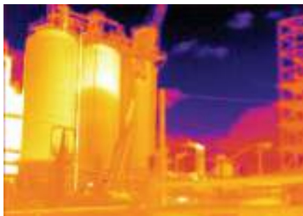
Рис. 5-61. При оптимальных условиях уровень жидкости в емкости для хранения легко увидеть.
