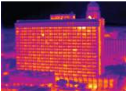
Рис. 5-12. Тепловизоры можно использовать для осмотра больших зданий и цехов для выявления неожиданных изменений температуры, которые могут указывать на возможные проблем.
