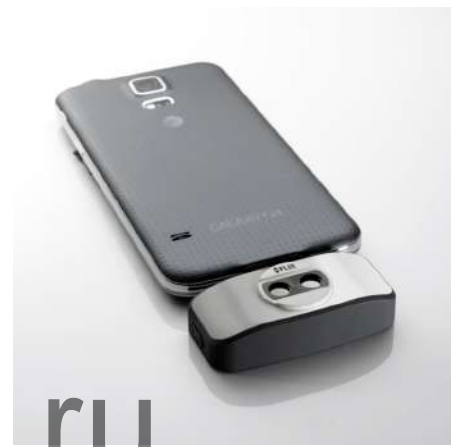
Рисунок 37.3 2015 г.: FLIR One, вспомогательное устройство для мобильных телефонов с операционной системой iPhone и Android. Вес: 90 г. .
