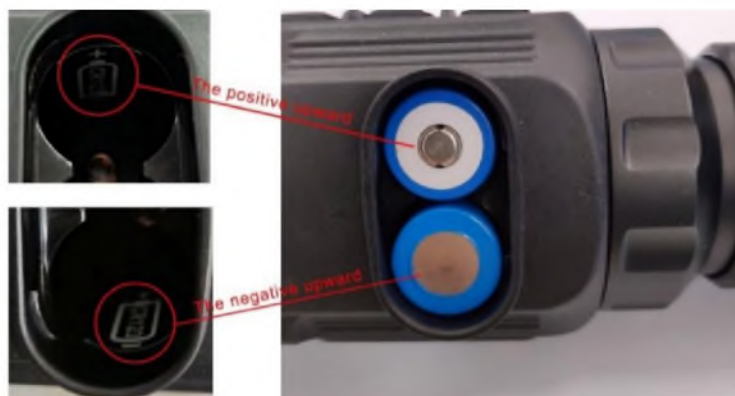
Рис. 8 -1 Принципиальная схема установки аккумуляторной батареи
