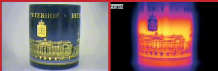
*При взгляде на ИК-изображение может показаться, что золотистая краска холоднее, чем поверхность чашки. В действительности они имеют одинаковую температуру: различия в интенсивности инфракрасного излучения обусловлены разной излучающей способностью*
