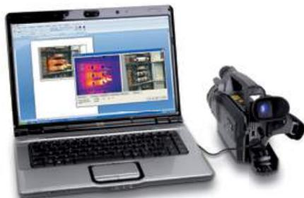
Большинство программных пакетов, поставляемых с тепловизионными камерами, позволяют выполнять базовый анализ и создавать отчеты. Они содержат функции измерения температуры в одной точке и другие базовые средства измерения.
