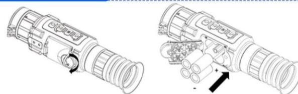
Как показано на рисунке: Поверните крышку батарейного отсека против часовой стрелки, чтобы открыть ее, и вставьте батареи в батарейный отсек так, чтобы их плюс был направлен внутрь. После этого поверните крышку батарейного отсека по часовой стрелке, чтобы плотно закрыть ее.
