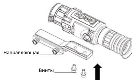
Установите устройство на направляющую, как показано стрелкой. Выровняйте отверстие в направляющей с винтами и с помощью шестигранного ключа вставьте винты и затяните их.
