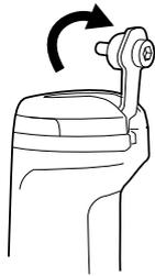
2. Извлеките аккумулятор из аккумуляторного отсека.
