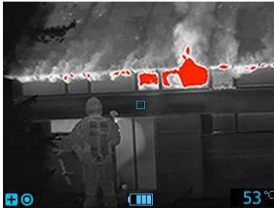
**Рисунок 12.5** Режим обнаружения тепла.
